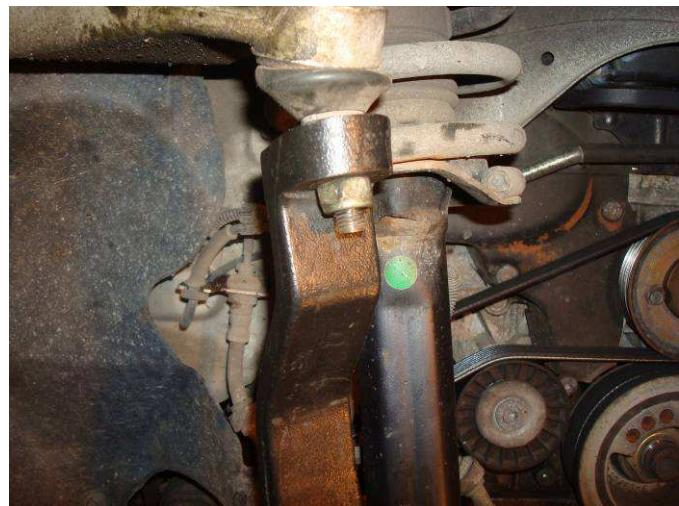
Connecter le tirant du boîtier de direction (1a) au montant de moyeu AV et le fixer en serrant l'écrou (1b)
