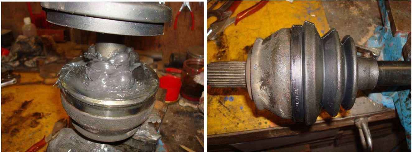
Engager la rotule coté boite au repère de démontage avec son soufflet, remettre le circlips.
