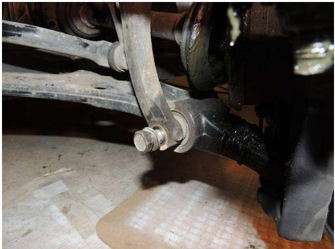
Visser et serrer les boulons de fixation du cardan coté boite (G) ou arbre intermédiaire. (D)
