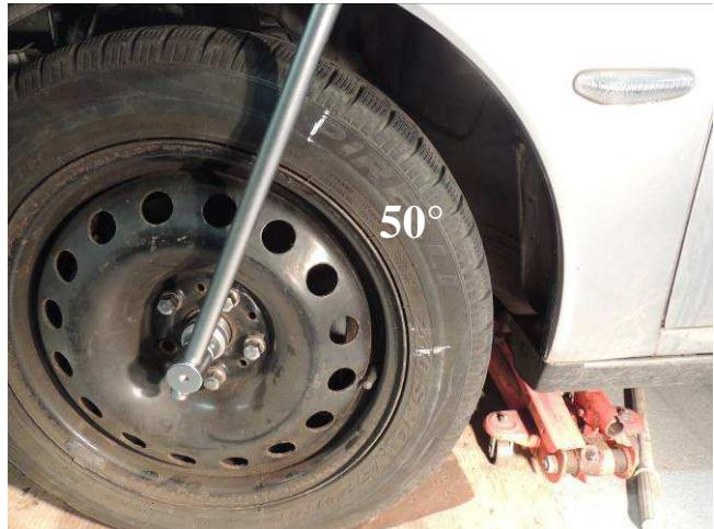
Installer le véhicule sur une chandelle et démonter la roue (outillage)
