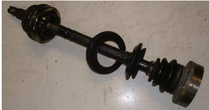
Enlever le circlip d'arrêt de la rotule coté boite, Repérer la position des cannelures
