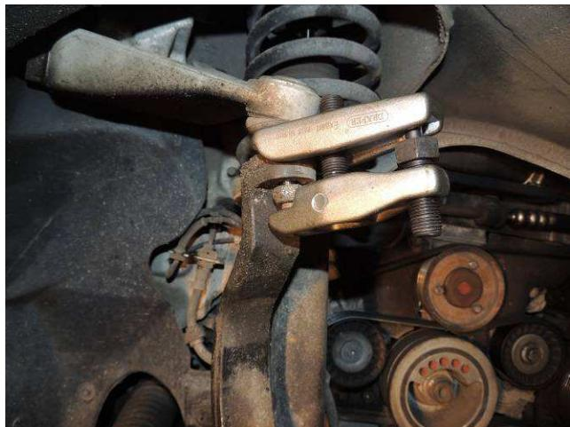
Dévisser l'écrou (1a) et détacher le tirant du boîtier droit de direction (1b) du support de moyeu AV à l'aide d'un extracteur de rotule (1c).
